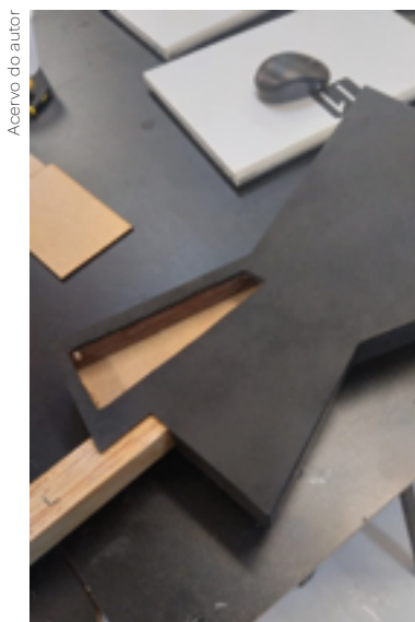
Figura 4: Contrabaixo com abertura para instalação de Arduino e componentes eletrônicos.
