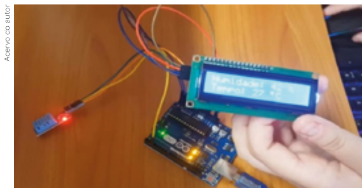
Figura 10: Protótipo para medição de umidade e temperatura do ar.
